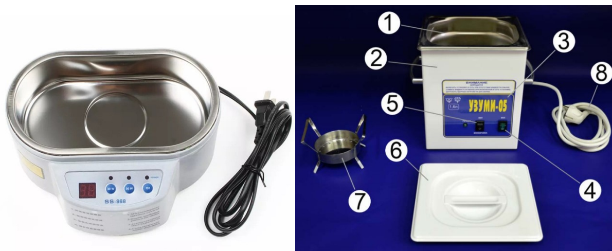
Рисунок 4.8 - Общий вид ультразвуковых установок: HIMOSKWA" (а) и УЗУМИ-05" (б): 1 - ультразвуковая ванна; 2 - корпус установки; 3 - лицевая панель; 4 – сетевой переключатель; 5 - переключатель блокировки включения ультразвука; 6 - крышка ванны; 7 - поддон-кассета; 8 - сетевой кабель.
