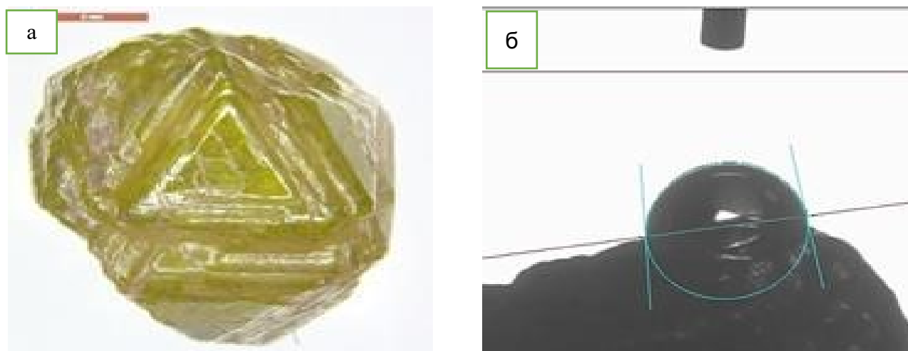
Рисунок 4.14 - Изображение кристалла алмаза (а) и капли жидкости (б) на поверхности техногенно гидрофилизированного кристалла крупности 3 мм с графоаналитическим измерением краевого угла смачивания
