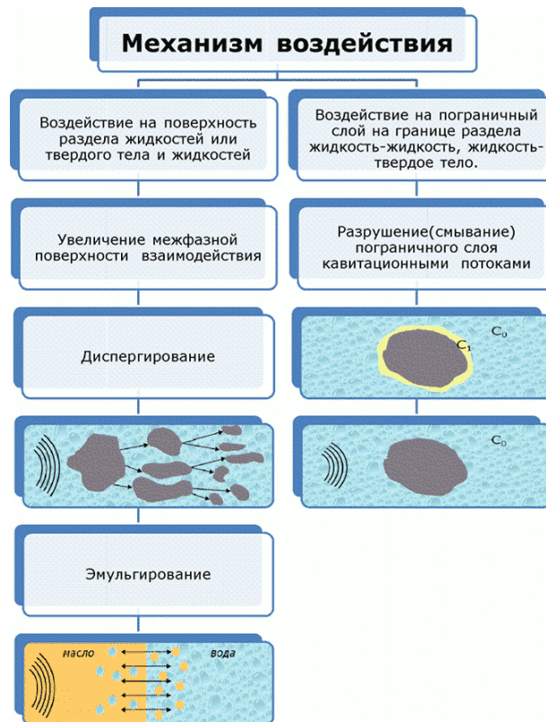
Рисунок 1.9 – Механизмы ускорения процессов в гетерогенных средах при ультразвуковых воздействиях [83]
