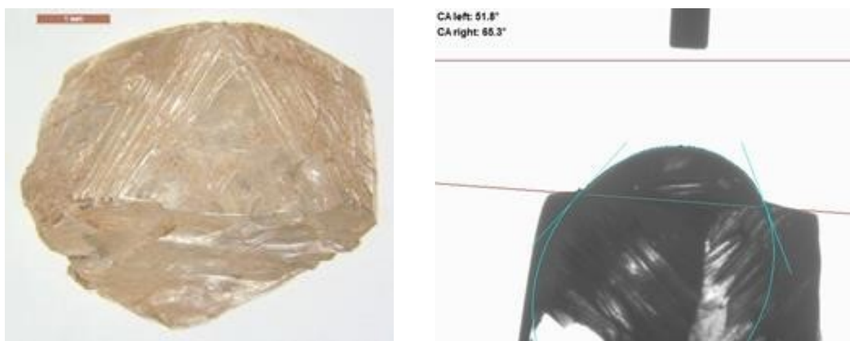
Рисунок 4.15 – Изображение кристалла алмаза (а) крупностью 3 мм со шламовым покрытием и капли жидкости (б) на его поверхности с графоаналитическим измерением краевого угла смачивания
