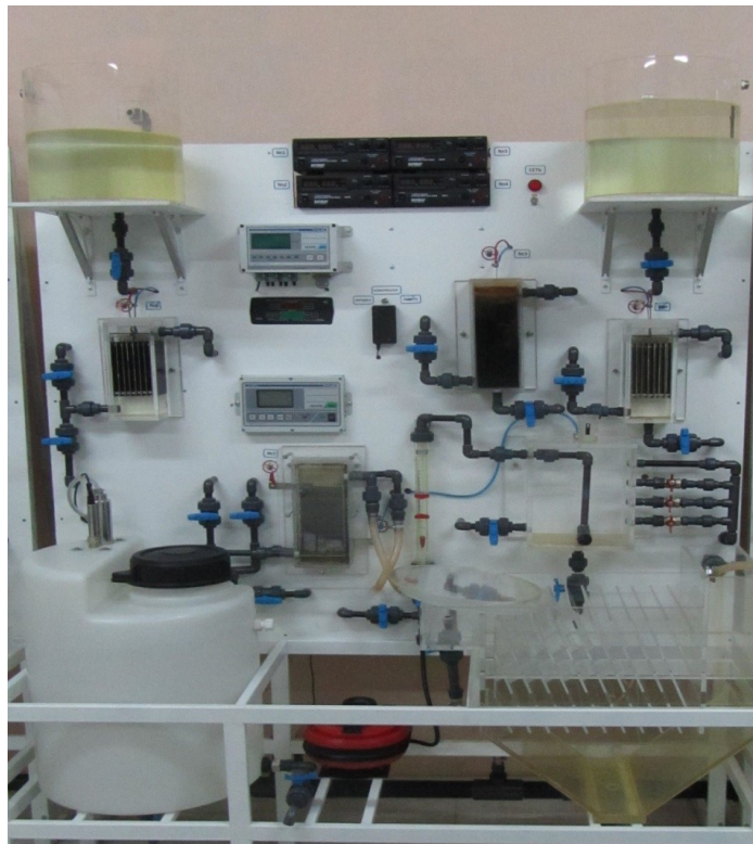
Рисунок 4.7 – Стендовая установка для проведения исследований процесса электрохимического кондиционирования водных систем, модифицирования и активации свойств минеральных компонентов
